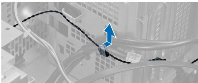
5. Pressione as patilhas em ambos os lados para desbloquear e retirar o sensor térmico do chassis.
