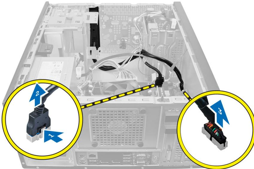
4. Retire e solte o painel de E/S, o cabo de dados e o cabo de dados USB do grampo no computador.
