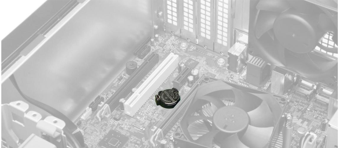
4. Pressione o fecho de desbloqueio para o afastar da pilha, permitindo que esta salte do encaixe e depois levante-a para a retirar do computador.
