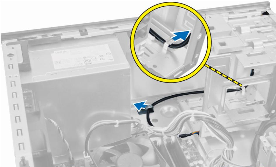
5. Carregue nos grampos em cada extremidade do interruptor de alimentação para o soltar do chassis e faça-o deslizar para retirar o interruptor de alimentação com o seu cabo do computador.
